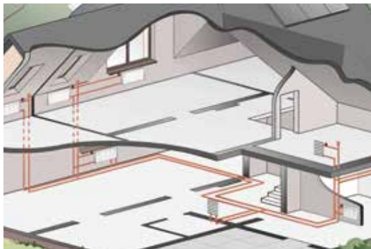
„Vertikālā” sistēma apkures instalācijā
